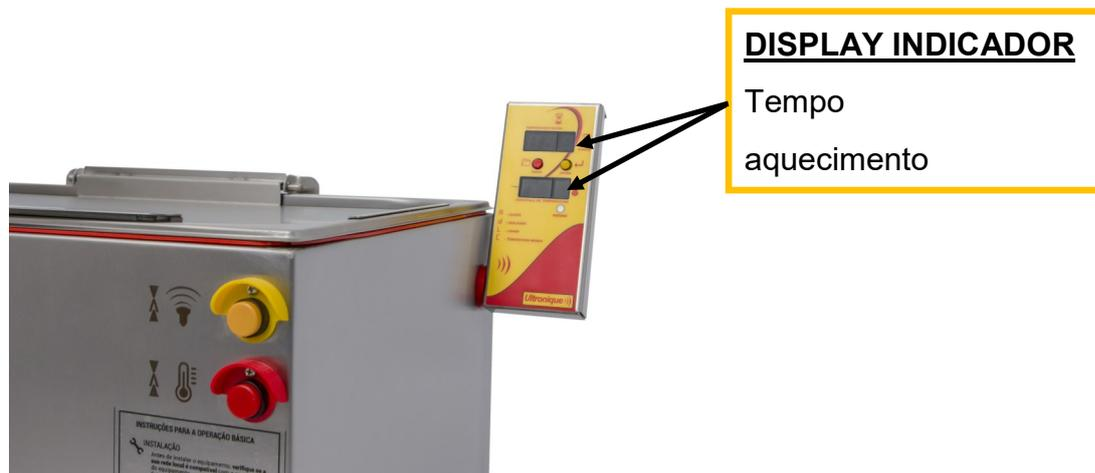
Sempre que o equipamento for ligado (cabo de força inserido em uma tomada funcional), ele iniciará uma rápida verificação e em seguida, exibirá o último valor de tempo que foi utilizado e a indicação de desligado.
