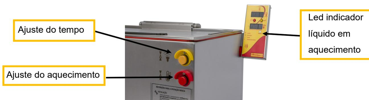
Com o aparelho ligado, inicialmente, observe que o display “**TEMPERATURA**”, indicará o ultimo ajuste e a letra “**d**” de DESLIGADO;
