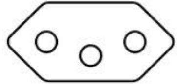
Lembrando ainda que esta tomada deve estar na nova norma do INMETRO NBR-14136 (vide imagem) e que as instalações elétricas devem estar de acordo com a NBR-5410.
