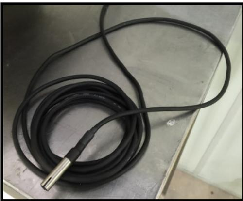
**Sensor de umidade externo**
