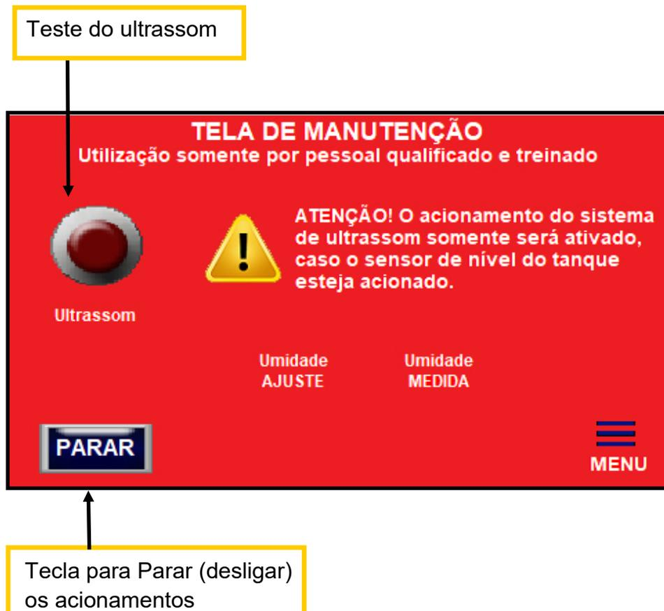
**NOTA IMPORTANTE:** o teste dos geradores de ultrassom é possível somente quando houver Nível dentro do módulo. Portanto caso o indicador de SENSOR DE NÍVEL estiver desligado, o equipamento não permitirá que o ultrassom seja acionado.
