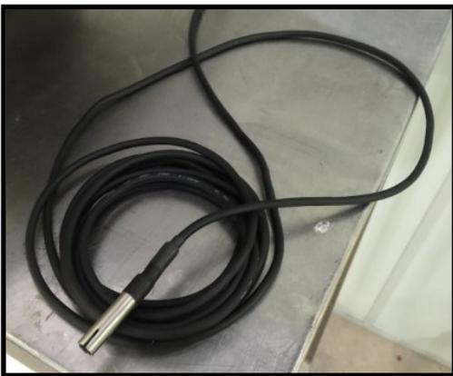
**Sensor de umidade externo**
